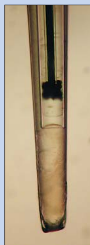
Spidsen af en nitritbiosensor set under mikroskop. Spidsdiametern er 0,03 mm.
